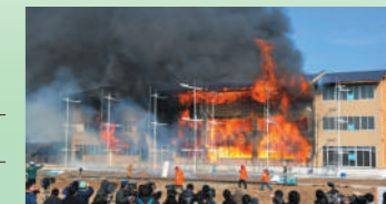
国土交通省が実施した木造校舎の実大火災実験。
