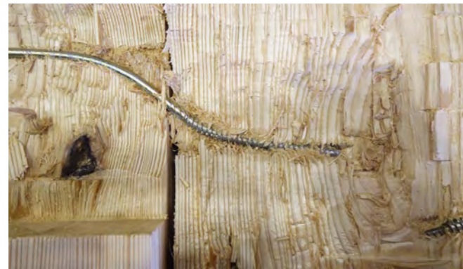
実験により破断された重ね梁の内部
